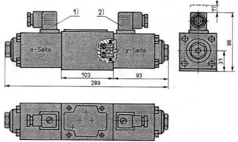
Anschlußbohrbild TGL 26 290, **DIN 24 340 CETOP**
