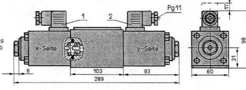
Wegeventil mit elektromagnetischer Stelleinheit (ohne Handzusatzbetätigung) und Abschlußgehäuse für zwei Schaltstellungen
