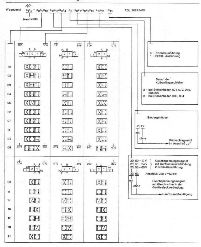
In der Bezeichnung von Wegeventilkombinationen mit Stelleinheiten  $x_8x_9x_{10}=071;072;079$  werden die Stellen  $x_{11}x_{12}$  mit Null ausgeschrieben, da diese Stelleinheiten keinen Spannungsanschluß besitzen (siehe Beispiel). Zur Unterscheidung der Stelleinheiten am Wegeventil wird außerdem die Bezugsseite "x" und "y" unterschieden. Die Schaltfunktion  $x_3x_4=09$  ist nur mit den Stelleinheiten  $x_8x_9x_{10}=307$  bzw. 079 zu kombinieren.
