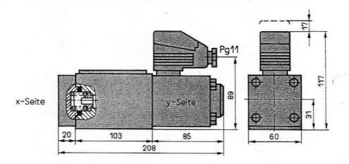
Wegeventil mit einer elektromagnetischen Stelleinheit mit Rastung und einer elektromagnetischen Stelleinheit für zwei Schaltstellungen
